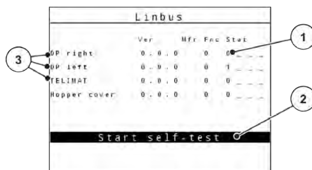
Att. 44: Pārbaude/diagnostika; piemērs: Linbus
