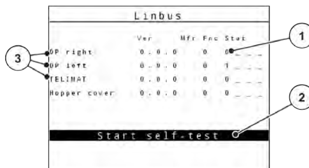
Kuva 44: Testi/diagnoosi, esimerkki: LIN-väylä
