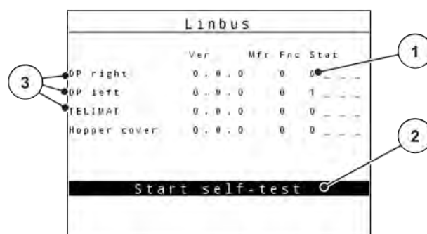
Fig. 44: Test/diagnoză; exemplu: Linbus
