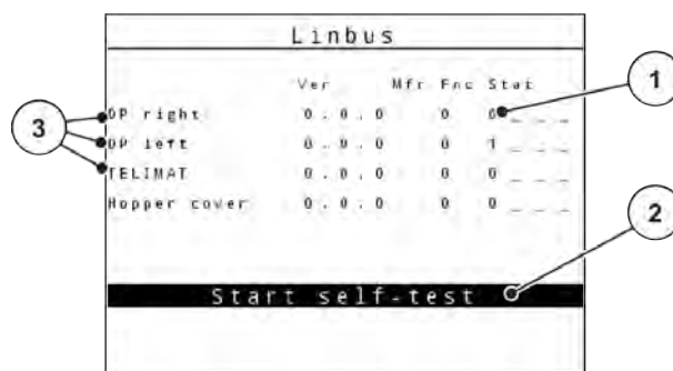
Рис. 44: Тест/диагностика; пример: Linbus
