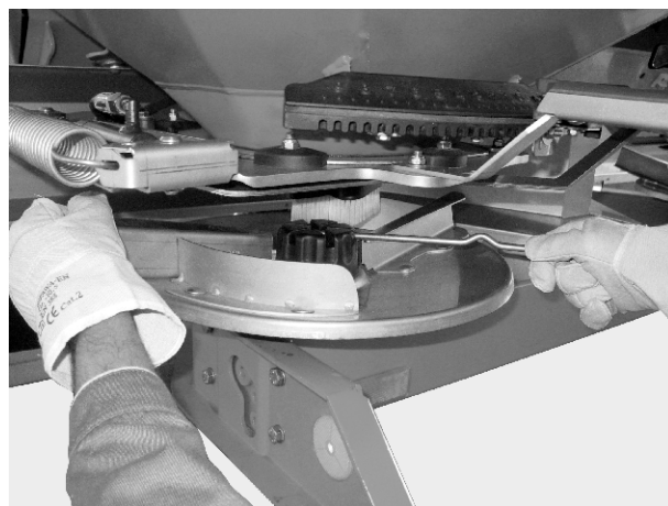
Рис. 37: Ослаблення ковпачкової гайки
