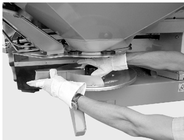
Рис. 40: Затягування ковпачкової гайки
