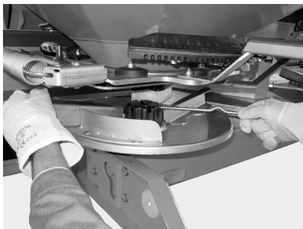
Рис. 27: Ослаблення ковпачкової гайки
