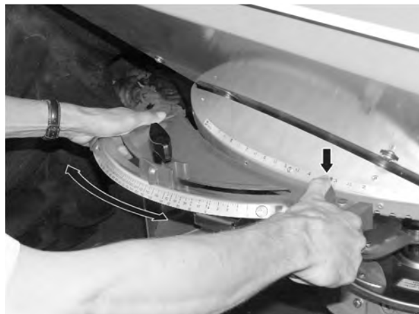
Sl. 30: Nastavitvena konzola za izstopno odprtino
