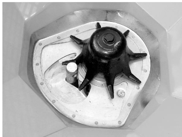
Sl. 60: Zatič spodnjega vodila v dozirni odprtini
