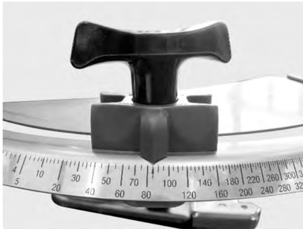
Obr. 60: Stupnica na nastavenie dávkovacieho posúvača
