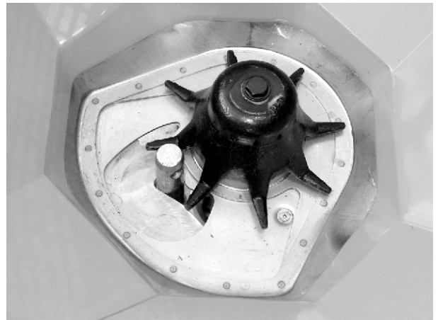
Fig. 60: Trekkstangbolt i doseringsåpning
