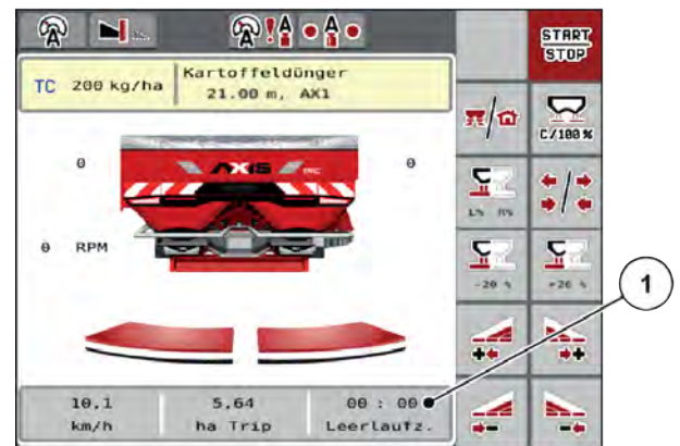
Fig. 31: Afișare măsurare la mers în gol în ecranul de operare
