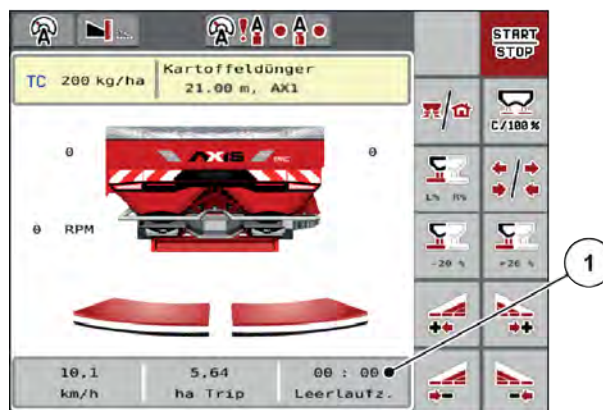
Рис. 31: Индикация измерения холостого хода на рабочем экране
