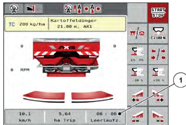
Kuva 31: Tyhjäkäyntimittauksen näyttö käyttökuvasssa
