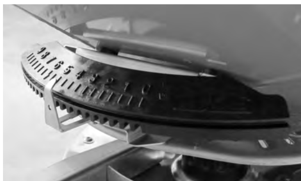
図 40: 放出ポイント調整の様子(例)
