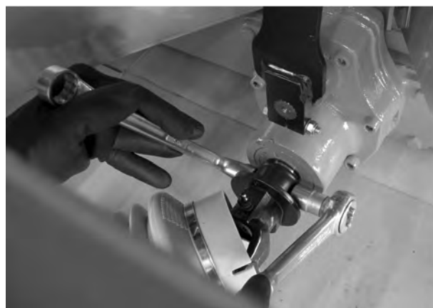
図 13: ドライブシャフトを固定
