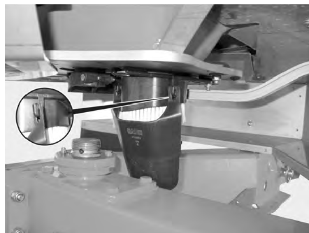
Σχ. 38: Ανάρτηση ολισθητήρα δοκιμής βαθμονόμησης
