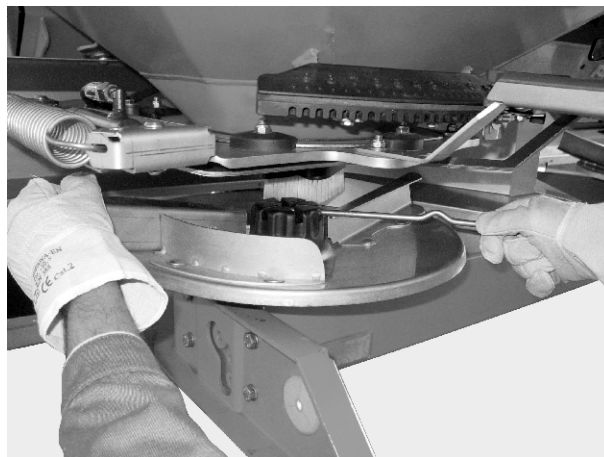
Σχ. 28: Χαλάρωση τυφλού παξιμαδιού
