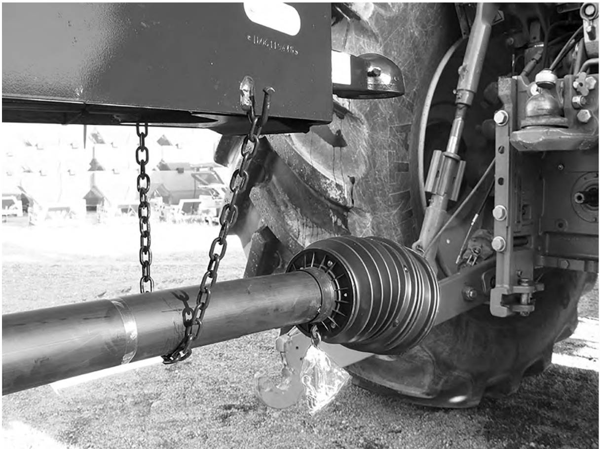
Рис. 24: Відкладання карданного вала
