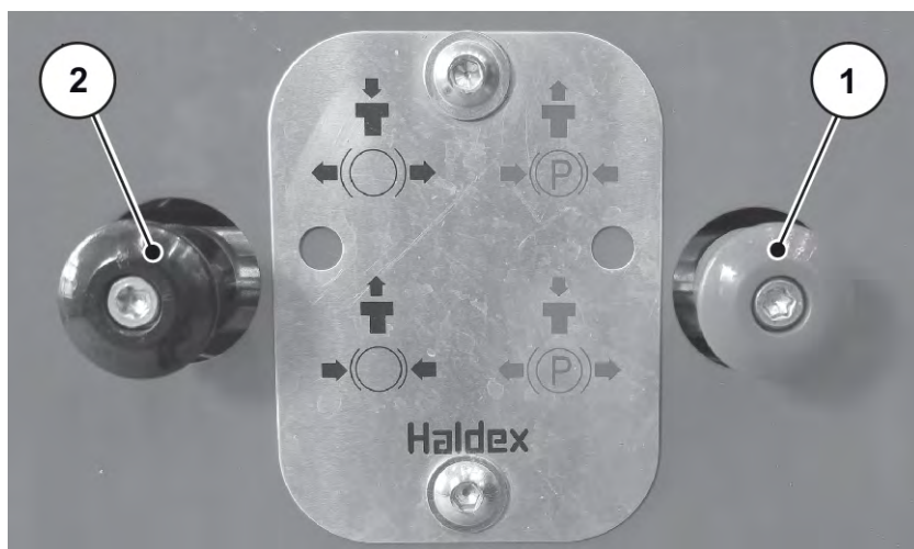
Рис. 53: Затягування ручного стоянкового гальма
