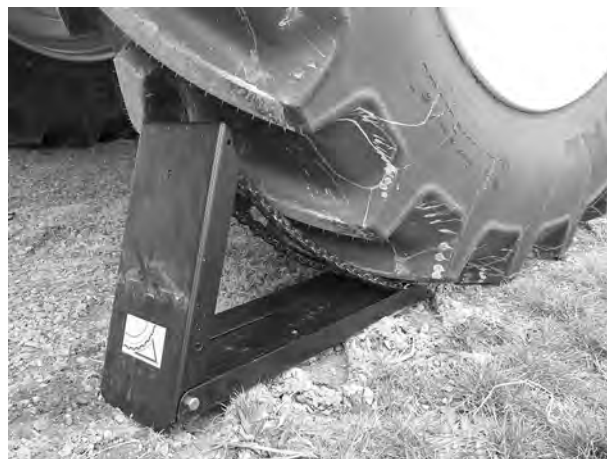
Рис. 55: Позичонування противідкатного упору
