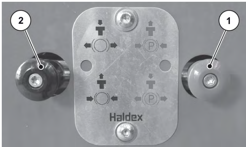
Fig. 53: Trækning af manuel parkeringsbremse
