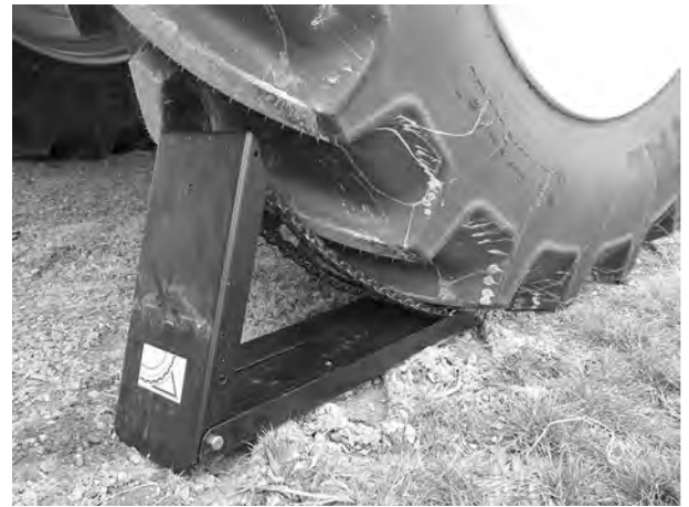
Fig. 55: Poziționarea calei de roată
