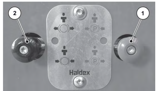
Fig. 43: Eliberare frână de imobilizare
