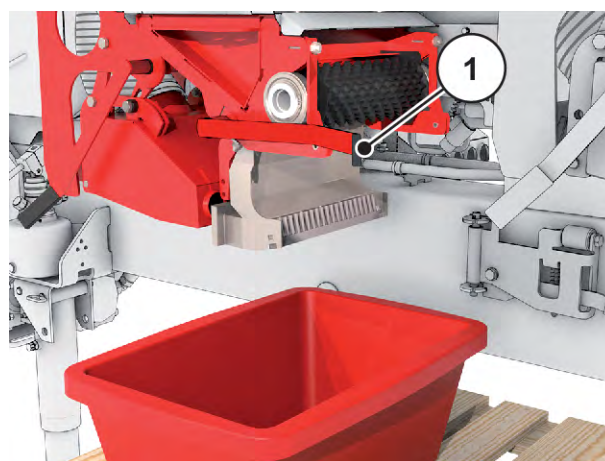
Fig. 52: Așezarea vanei de împrăștiere dedesubt
