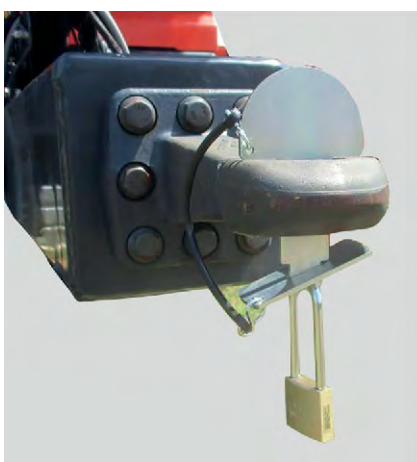
Fig. 10: Siguranță împotriva utilizării neautorizate a dispozitivelor de remorcare
