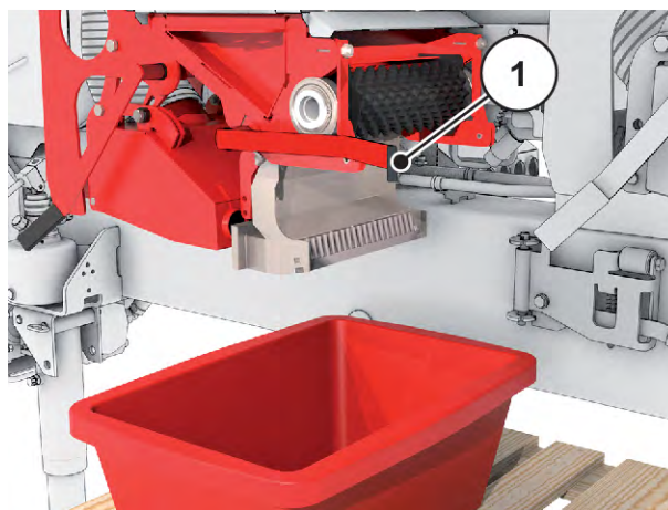
Рис. 52: Установка распределительного лотка
