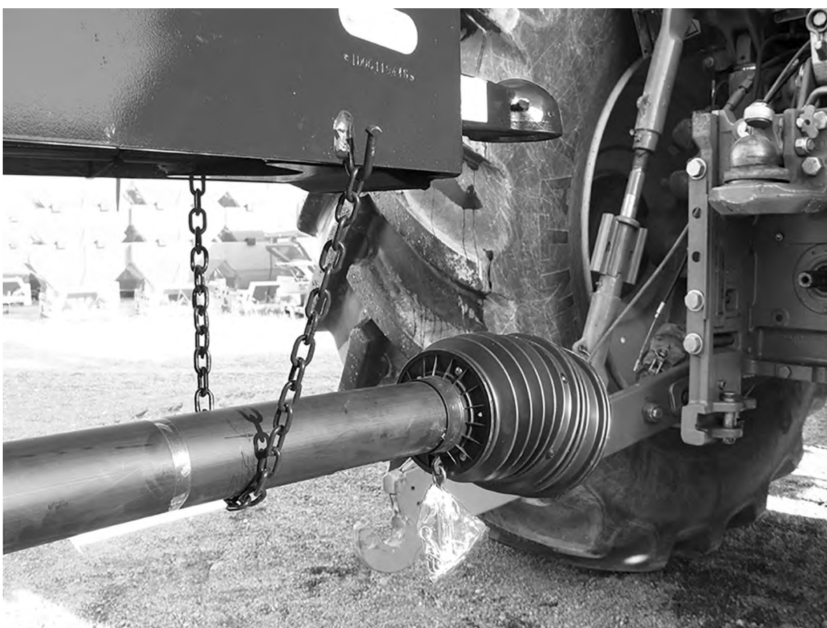
Obr. 24: Uložení kloubového hřídele
