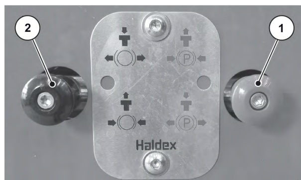
Obr. 43: Odbrzdní parkovací brzdy
