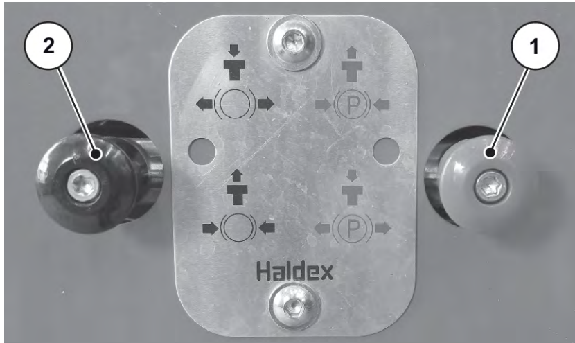
Obr. 53: Ruční zatažení parkovací brzdy
