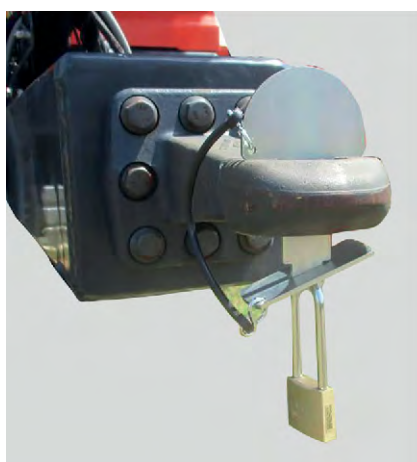
Obr. 10: Pojistka proti neoprávněnému použití tažných zařízení
