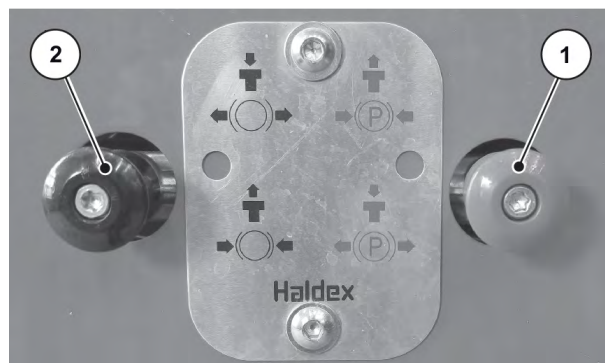
Fig. 43: Desserrer le frein de stationnement
