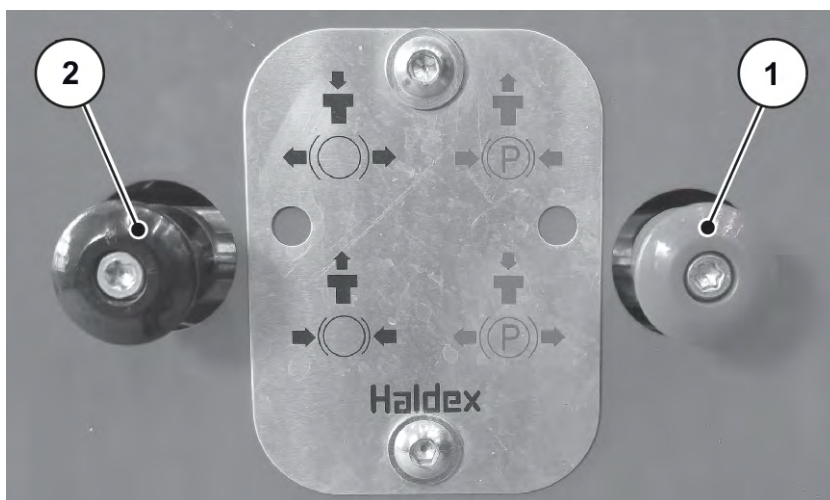
Rys. 53: Zaciąganie ręcznego hamulca postojowego
