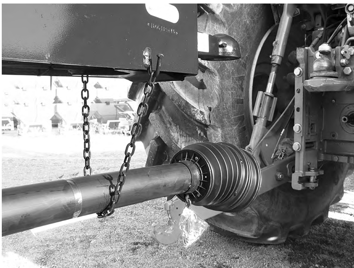
Rys. 24: Odkładanie wału przegubowego
