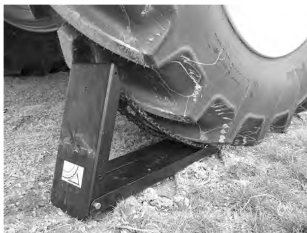
Rys. 55: Ustawianie podkładki klinowej
