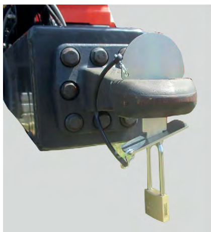
Rys. 10: Zabezpieczenie przed nieuprawnionym użytkowaniem zaczepu holowniczego
