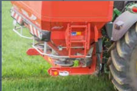
AXIS H – krajové rozmetání vpravo a vlevo nastavením otáček a bodu výpadu
