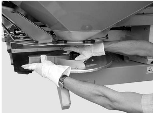
**Bild 8.4:** Hutmutter abschrauben
