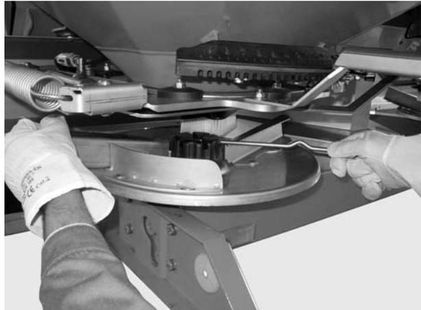
**Bild 8.3:** Hutmutter lösen
