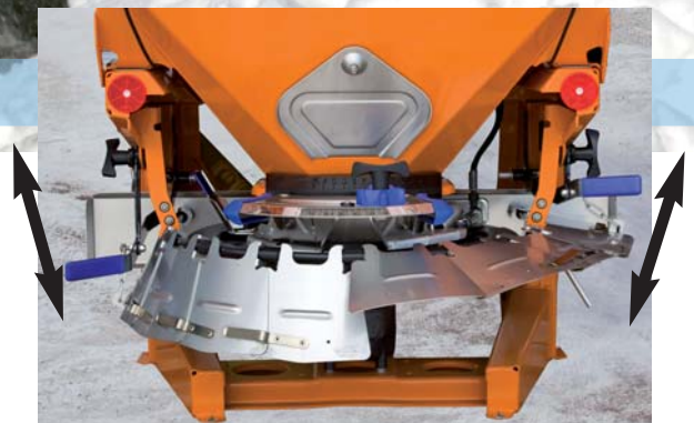
Gescheiden strooibreedtebeperking links en rechts
