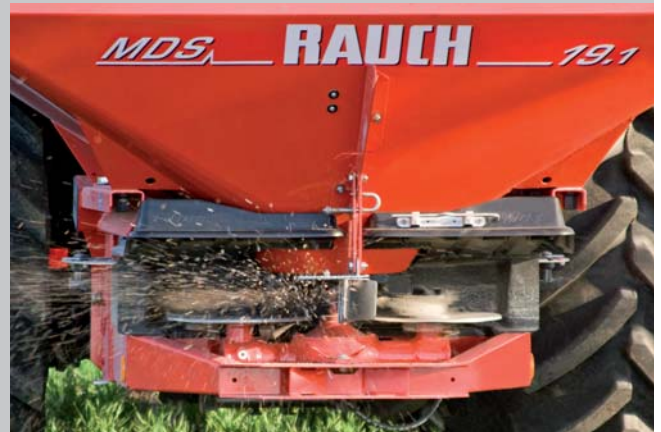
Пристрій для розкидання добрива на межі поля GSE 6/GSE 7
