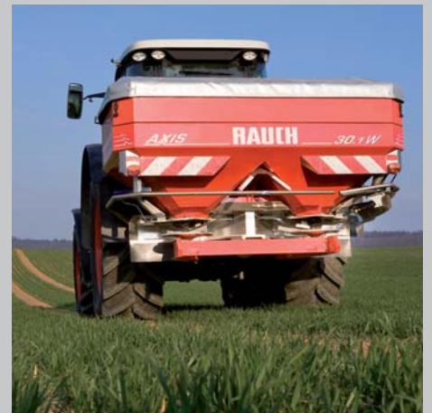
AXIS 30.1 W med vejeceller Arbejdsbredde 12 - 42 m Maks. nyttelast 3.000 kg
