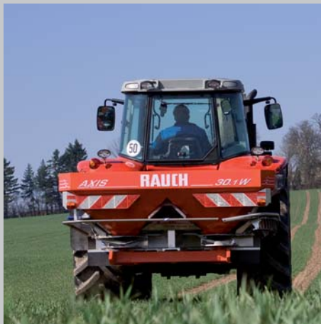
AXIS 30.1 Arbejdsbredde 12 - 42 m Maks. nyttelast 3.000 kg
