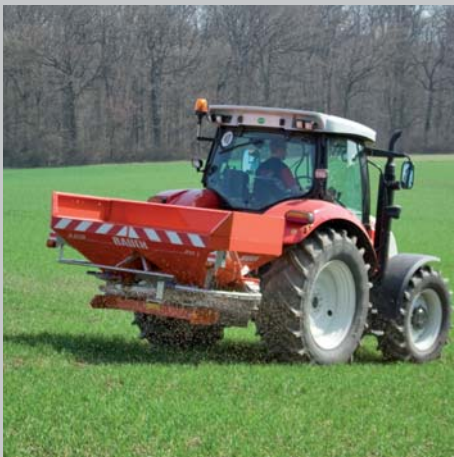
AXIS 20.1 Arbejdsbredde 12 - 28 m Maks. nyttelast 2.100 kg
