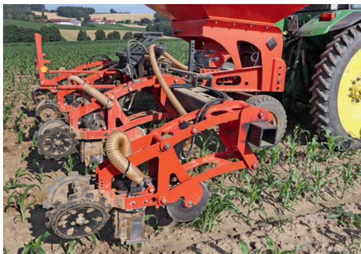
Die vier Reihen werden pneumatisch mit Dünger versorgt.
