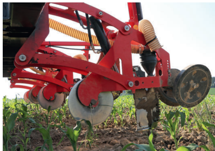
In einem Parallelogramm hängen Schar, Schar und Andruckrolle.
