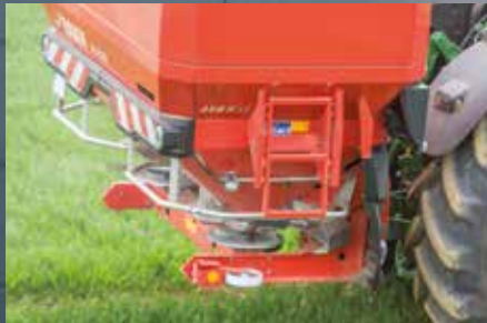
AXIS H - Extensión del borde a derecha e izquierda mediante el ajuste de la velocidad y el punto de aplicación
