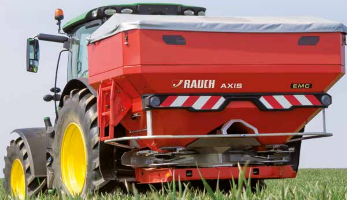
AXIS EMC - Μέτρηση ροπής με αισθητήρες μαγνητοσυστολής (γνωστοί από τα ηλεκτρονικά ποδήλατα και τα segway)
