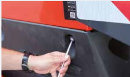
Λασπωτήρες με γρήγορη αποσύνδεση
