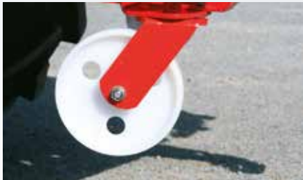
Τροχοί απόθεσης με σύστημα ταχείας σύζευξης
