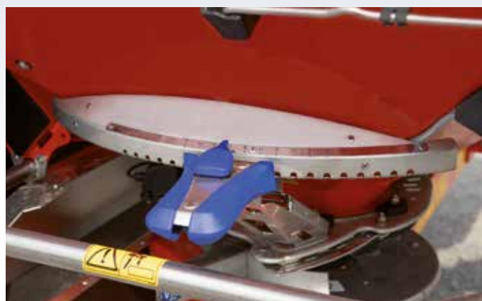
Manualna regulacja punktu spadania nawozu na tarczę
