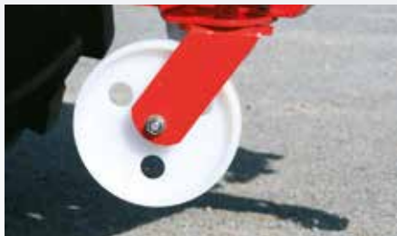
Ролики останова с системой быстрого соединения
