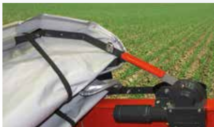
Защитный тент с электрическим дистанционным управлением
