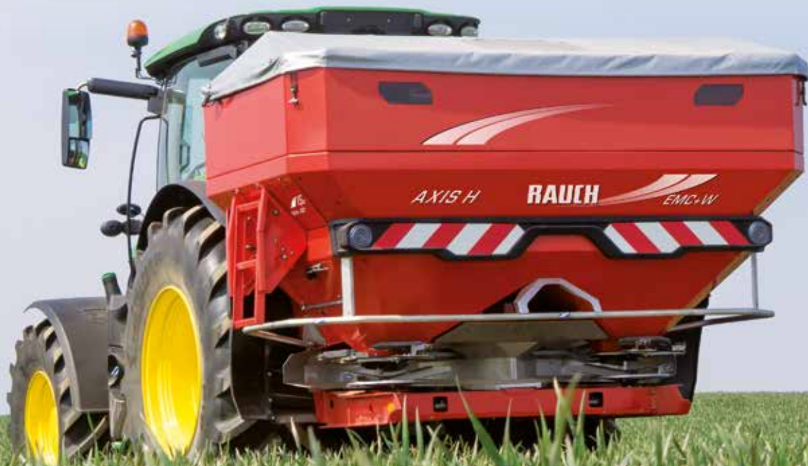
AXIS EMC - vridmomentsmätning med magnetostriktionssensorer (som används på E-Bikes och Segways)
