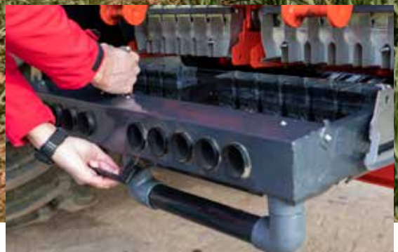
Injektorkassetten kan enkelt svängas bort
