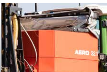
Tillval med fjärrstyrd presenning med AP-Drive
