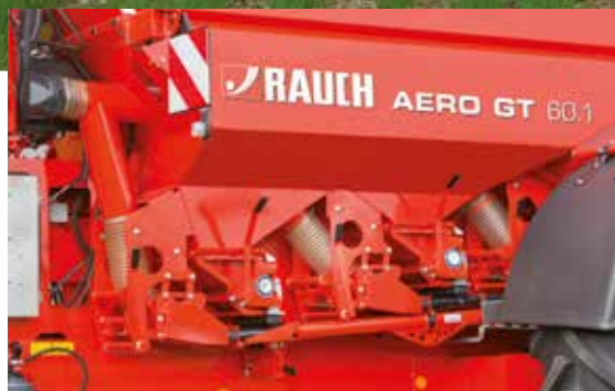
Tre separat reglerbara doseringsenheter på varje sida
