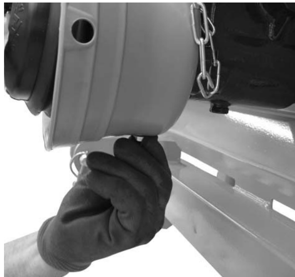
Ілюстрація 6.5. Вставлення гвинта з шестигранною головкою
