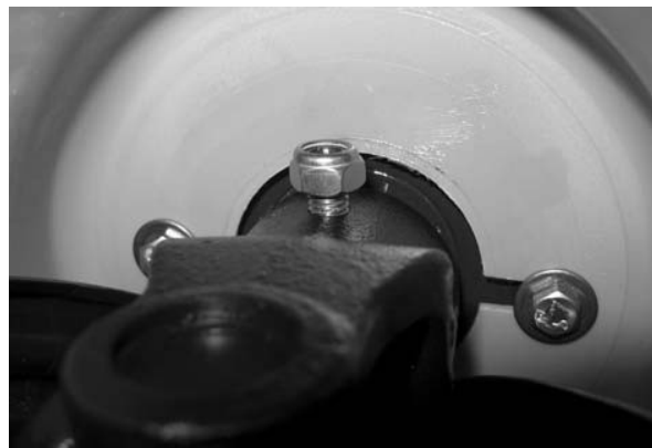
Ілюстрація 6.6. Затягнення болта з шестигранною головкою
