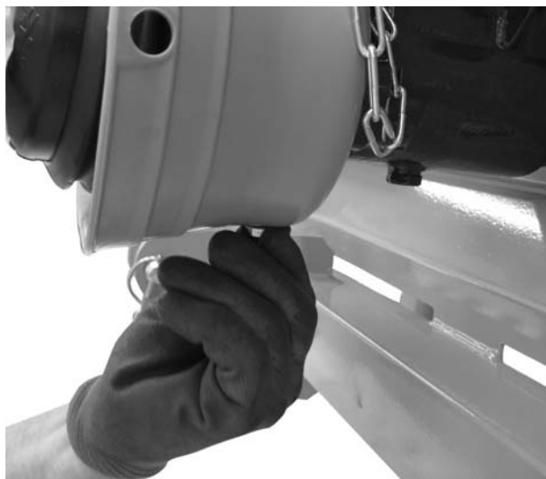
Rysunek 6.5: Wprowadzenie śruby z łbem sześciokątnym
