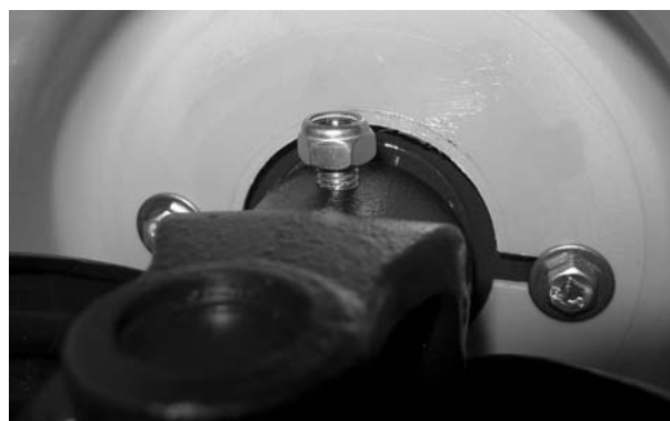
Rysunek 6.6: Dokręcanie śruby z łbem sześciokątnym
