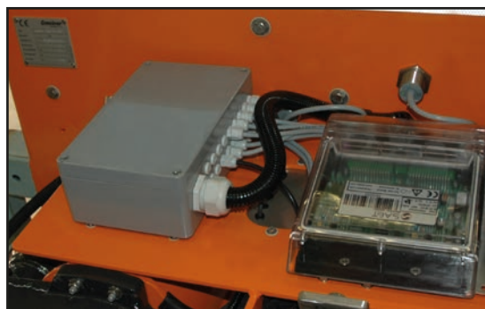
Skrzynka rozdzielcza z czarną skrzynką w komorze sprzętowej
