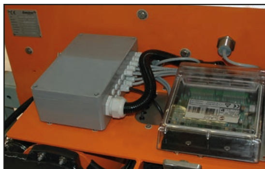
Boîtier de distribution avec boîte noire à l'intérieur de l'appareil
