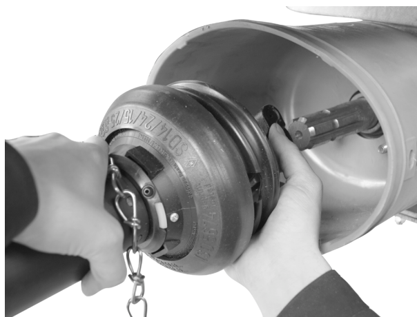
Obr. 7: Nasadenie kĺbového hriadeľa na výstupný hriadeľ prevodovky
