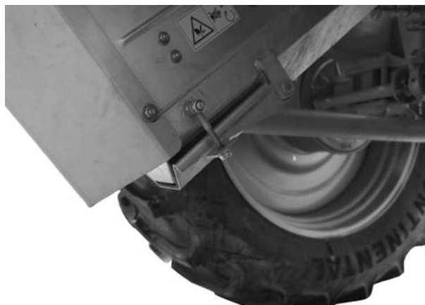
Slika 7.3: Poklopac za pražnjenje ispod rezervoara
