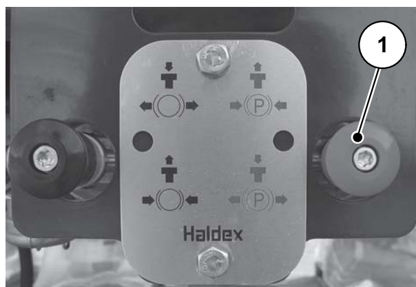
Billede 7.1: Slækning af parkeringsbremsen
