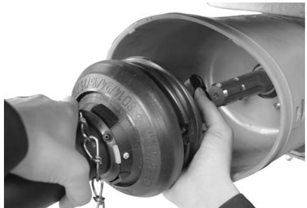
Billede 6.1: Montering af kardanakslen på akseltappen
