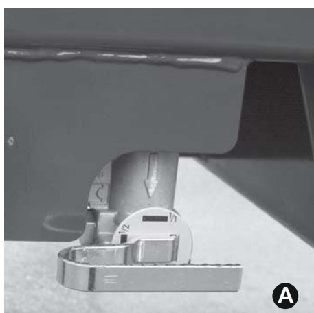
Billede 6.21: Indstilling af bremsekraftfordeleren
