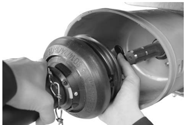
Bild 6.1: Sätt på kraftöverföringsaxeln på växeltappen.
