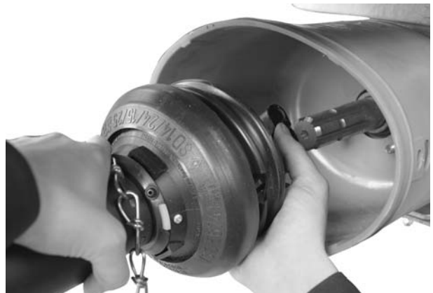
Imagine 6.1: Atașați arborele cardanic la fusul cutiei de viteze.
