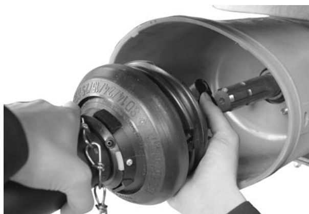
Joonis 6.1: Kardaanhvõlli asetamine ülekandetapile
