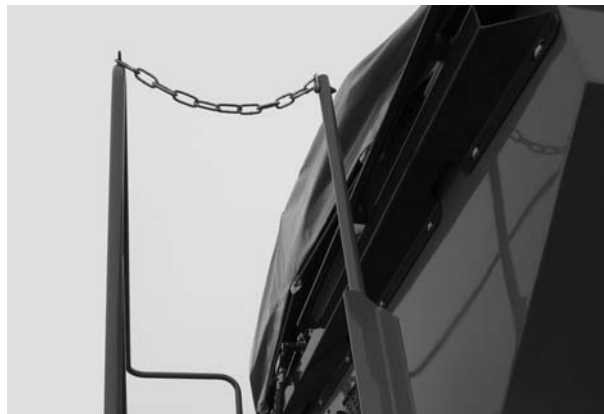
Joonis 6.19: Kinnituskett platvormi kaitseks volitamata juurdepääsu eest
