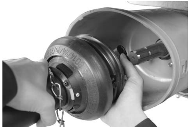
Obrázek 6.1: Nasadte kloubový hřídel na čep převodovky.
