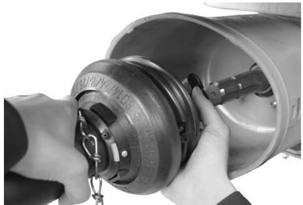
Rysunek 6.1: Wsuwanie wału przegubowego na czop przekładni
