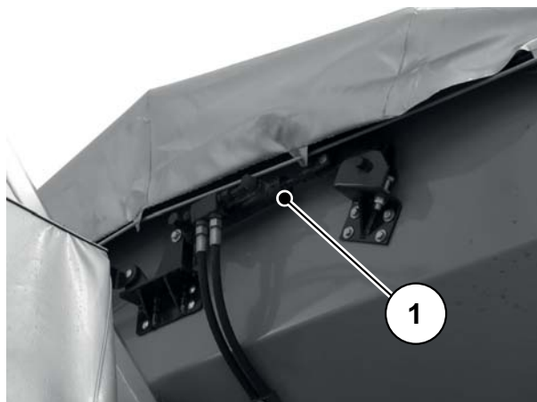
Rysunek 9.5: Siłownik hydrauliczny plandeki – tył
