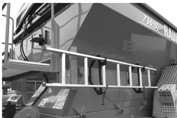
Rysunek 6.20: Drabinka w pozycji transportowej
