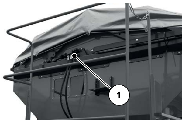
Rysunek 9.4: Siłownik hydrauliczny plandeki – przód
