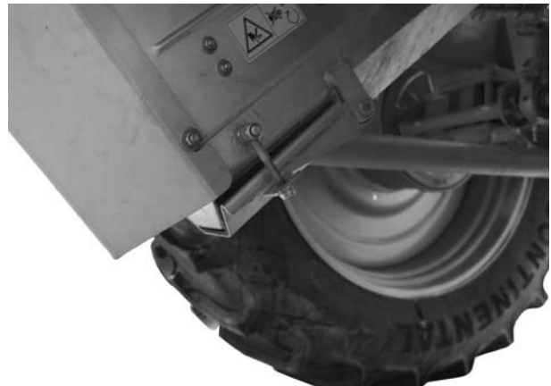
Rysunek 7.3: Kłapa opróżniająca pod zbiornikiem
