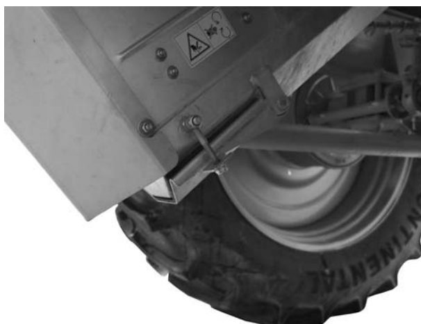
Rysunek 6.16: Kłapa szybkiego opróżniania
