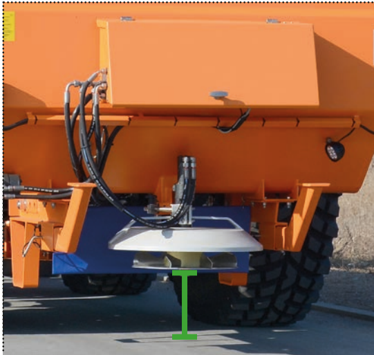
Hauteur de travail : Disque d'épandage de 35 à 45 cm au-dessus du sol
