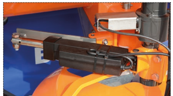
Réglage électronique du schéma d'épandage
