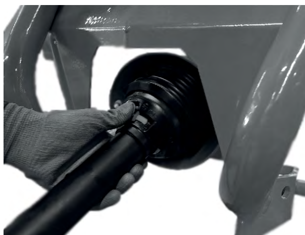
Fig. 14: Sett på kardangakselbeskyttelsen
