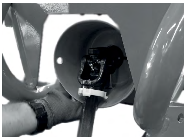
III. 12: Inserimento dell'albero cardanico sul perno del riduttore
