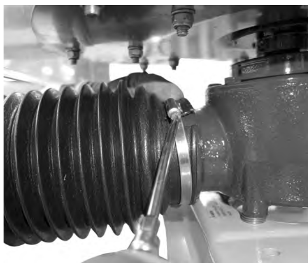
Рис. 16: Установка защитного кожуха карданного вала
