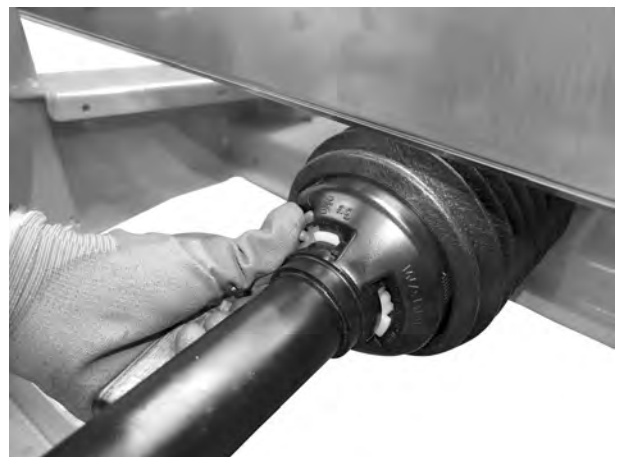
Att. 17: Kardānvārpstas aizsarga nofiksēšana
