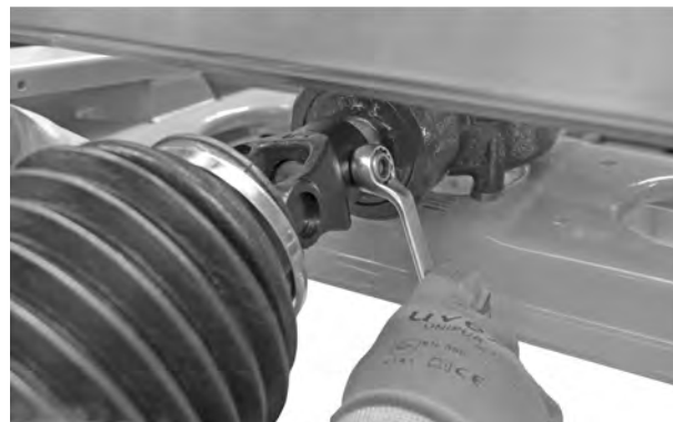
Fig. 15: Koble til kardangakselen
